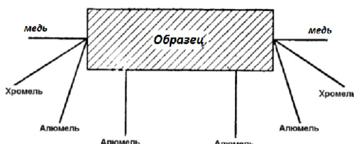
Рис. 9. Схема измерения теплопроводности термоэлектрических материалов методом Хармана
